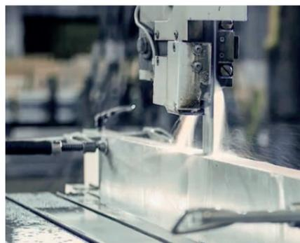
Die Maschinendatenerfassung bei der voestalpine ermöglicht vorausschauende Wartung der Sägeblätter.
