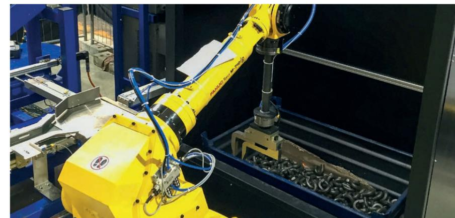
Colly 1.0 optimiert mit Bin-Picking Produktionsabläufe und ersetzt die manuelle Sortierung.
